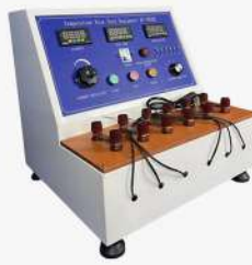
TEMP. RISE TEST APPARATUS
